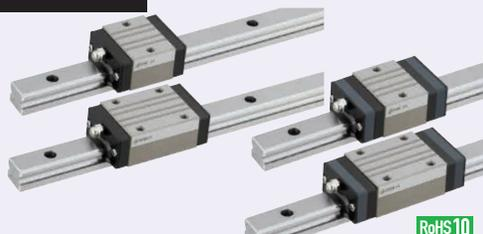
Les blocs et les glissières ne sont pas soudés séparément. Le type à écartement normal présente des écartements radiaux et des précisions garantis pour les ensembles de blocs et de glissières.
