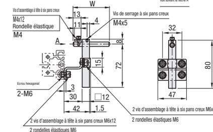
Les n° 55 - 80 ont différentes tailles de vis pour le montage du convoyeur. Sélectionner le boulon approprié en fonction de la courroie utilisée.
