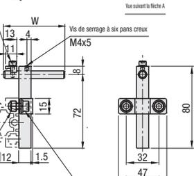
Les n° 55 - 80 ont différentes tailles de vis pour le montage du convoyeur. Sélectionner le boulon approprié en fonction de la courroie utilisée.
