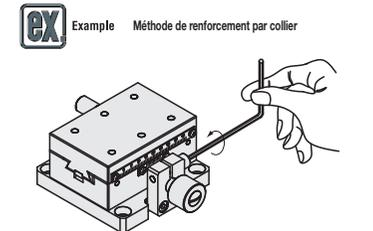
La retenue obtenue uniquement grâce au collier renforcé ne suffit pas à obtenir un jeu nul. Il est recommandé d'utiliser en plus une vis de collier.
