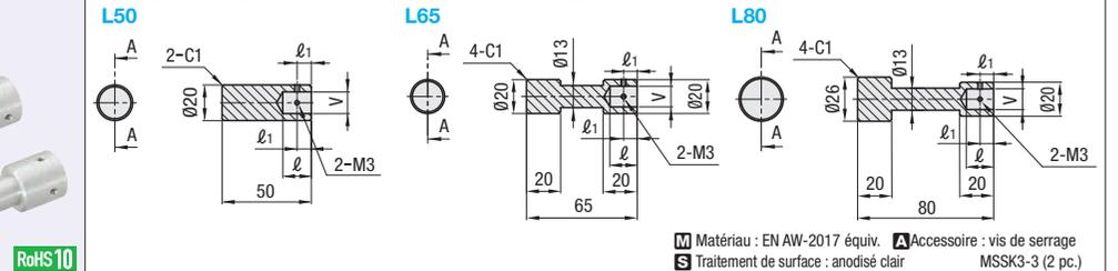
Matériau : EN AW-2017 équiv. Accessoire : vis de serrage MSSK3-3 (2 pc.)
