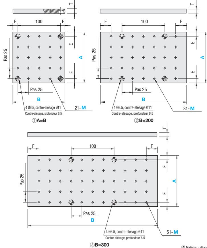
Les trous de montage pour les vis M6 avec un pas de 100mm sont placés au centre des plaques.
