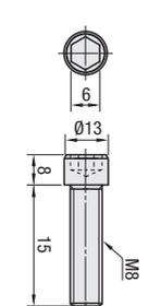
Un serrage excessif peut déformer les plaques de raccordement. (Couple de serrage de référence : 15N · m)
