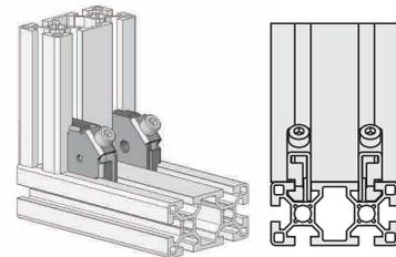
Pour les profilés extrudés en aluminium à 2 fentes, il est possible de monter un support des deux côtés.
