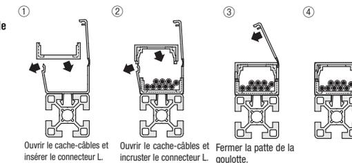
Ouvrir le cache-câbles et insérer le connecteur L.
