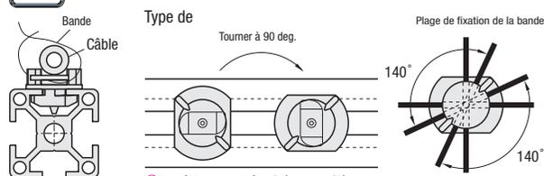
Les câbles peuvent être fixés aux profilés extrudés avec des attaches de câble.
