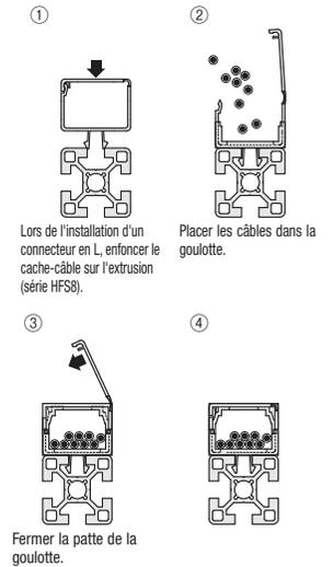
Lors de l'installation d'un connecteur en L, enfoncez le cache-câble sur l'extrusion (série HFS8).
