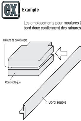
La dimension T du contreplaqué stratifié collé en aluminium est la dimension nominale. Se reporter à la "Dimension T réelle" dans le tableau ci-contre.
