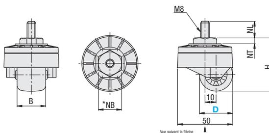
☑ Serrer la partie NB à l'aide d'une clé pour un serrage fiable.
